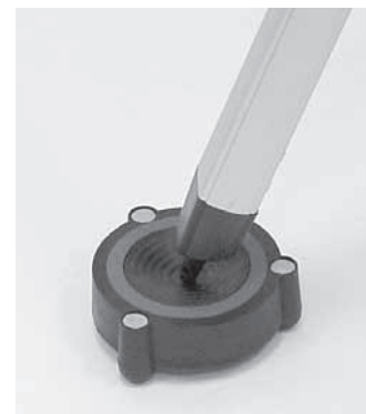
Figure 2b. Assurez-vous que le montant du trépied repose au centre exact du patin.
