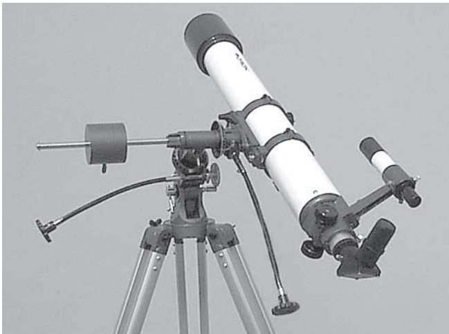
Abbildung 5a. Das Teleskop zeigt nach Süden. Beachten Sie, dass die Montierung und das Stativ in all diesen Darstellungen nicht bewegt werden, sondern nur die Rektaszensions- und Deklinationsachse eingestellt wird.
