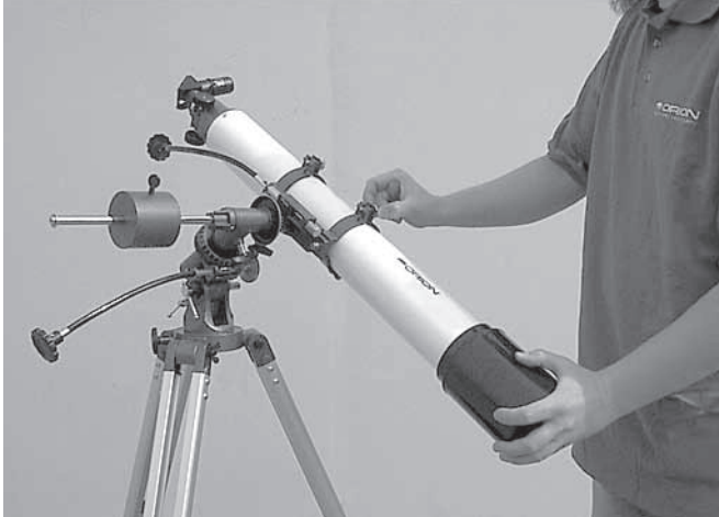
Abbildung 3d. Ausbalancieren des Teleskops auf der Dek-Achse. Hier ist das Teleskop nicht ausbalanciert (und kippt).
