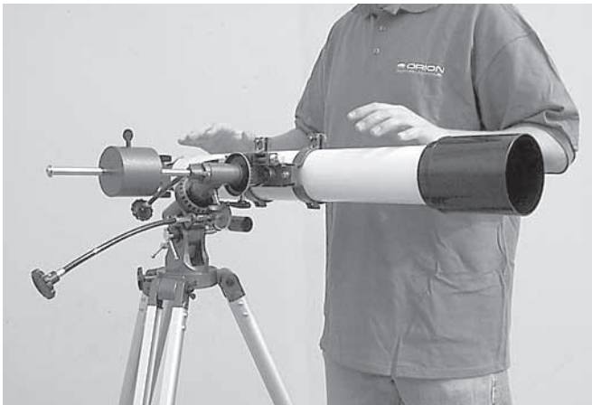
Abbildung 3e. Das Teleskop ist nun auf der Dek-Achse ausbalanciert, d. h. es bleibt auch dann in der Waagerechten, wenn es nicht mit der Hand gestützt wird.
