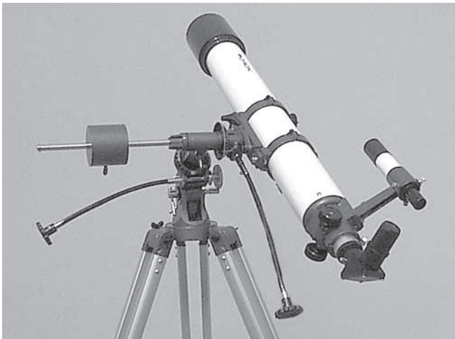
Figura 5a. Telescopio apuntando al sur. Tenga en cuenta que en todos estos ejemplos, la montura y el trípode permanecen estacionarios, solo los ejes de A. R. y Dec. se mueven.
