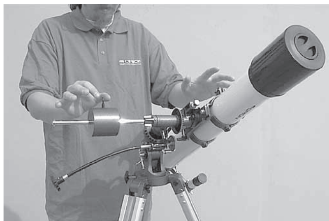
Figura 3b. Ahora el telescopio estará equilibrado respecto al eje de ascensión recta. Es decir, al soltar las manos, el eje de contrapeso se mantiene en posición horizontal.
