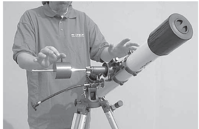
Figure 3b. Le télescope est maintenant en équilibre sur l'axe d'ascension droite. Autrement dit, l'axe de contreponds reste horizontal lorsque vous le lâchez.
