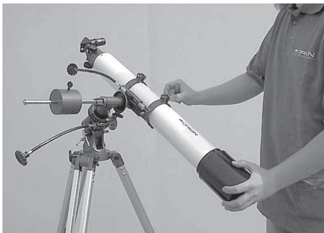
Figure 3d. Équilibrage du télescope par rapport à l'axe de déclinaison. Comme on le voit ici, le télescope est déséquilibré (inclinaison).
