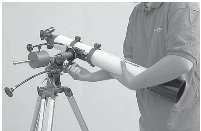
Figure 3c. Préparation de l'équilibrage du télescope sur l'axe de déclinaison en débloquent d'abord le bouton de blocage de la déclinaison.
