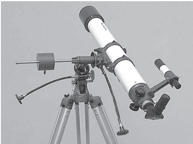
Figure 5a. Télescope orienté vers le sud. Notez que sur toutes ces illustrations, la monture et le trépied restent immobiles. Seuls les axes d'ascension droite et de déclinaison se déplacent.
