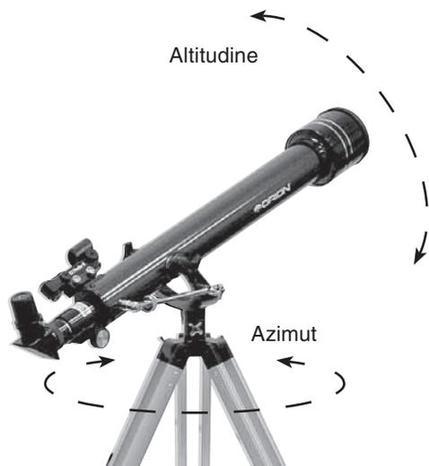
**Figura 5.** Il telescopio Observer 60 consente il movimento su due assi: altitudine e azimut.
