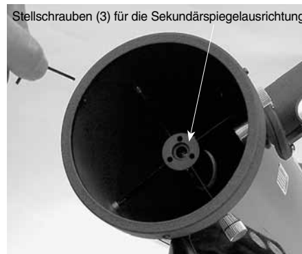
Abbildung 10. Stellen Sie die Neigung des Sekundärspiegels durch Lockern oder Festziehen der drei Stellschrauben für die Sekundärspiegeljustierung mit einem Innensechskantschlüssel (2 mm) ein.
