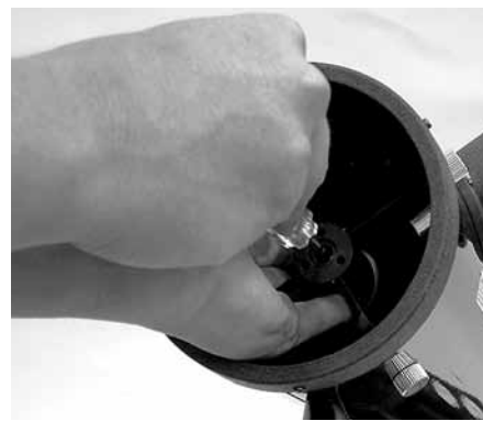
Abbildung 9. Zum Zentrieren des Sekundärspiegels unter dem Fokussierer halten Sie den Spiegelhalter mit den Fingern fest, während Sie die mittlere Schraube mit einem Kreuzschlitz-Schraubendreher festziehen. Berühren Sie keinesfalls die Spiegelfläche.
