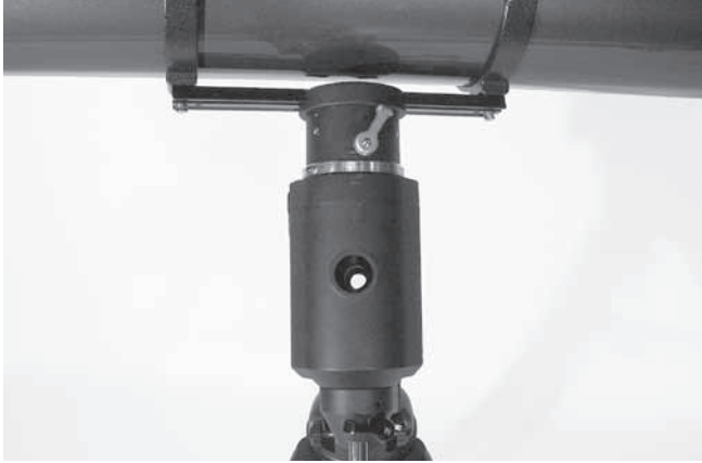
Abbildung 8. Das Optiktrohr muss um die Deklinationsachse gedreht werden, um durch den Polsucher schauen zu können.
