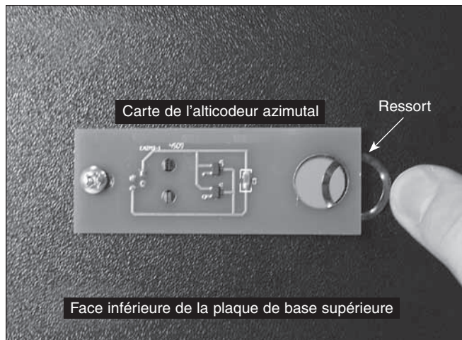
Figure 7. Placez le ressort ondulé entre le bord de l'encodeur d'azimut et de la plaque de base et alignez l'intérieur du ressort ondulé avec le trou central dans la plaque de base.
