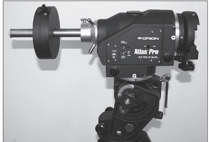
Abbildung 15. Einzelnes in der azimutalen Konfiguration eingerichtetes Teleskop mit einem zusätzlichen Gegengewicht.
