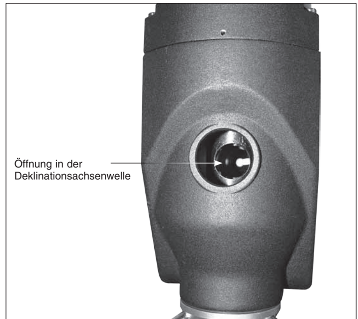
Abbildung 22. Drehen Sie, um durch den Polsucher zu schauen, die Montierung so lange über die Deklinationsachse, bis die Öffnung in der Deklinationsachsenwelle in einer Linie mit der Öffnung im Gehäuse der Montierung steht.
