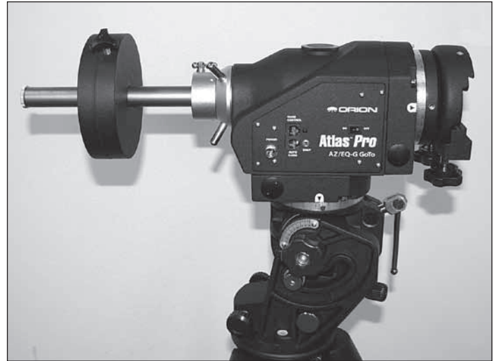
Figura 15. Montura de telescopio individual configurada en modo altacimutal, con un contrapeso añadido.
