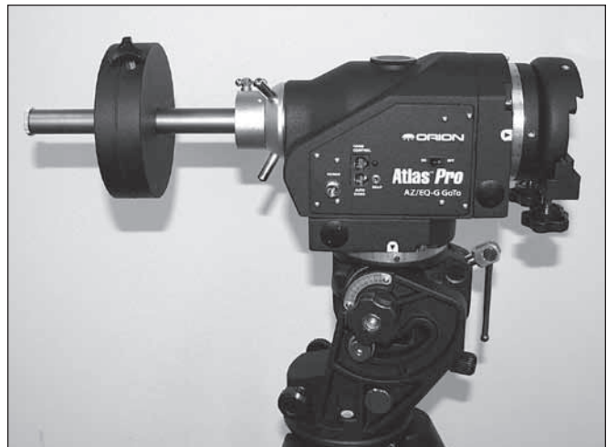
Figura 15. Configurazione della montatura con un solo telescopio in modalità altazimutale con un contrappeso aggiunto.
