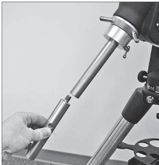
Figura 9. La barra di contrappeso da 15 cm in dotazione si avvita nella parte inferiore dell'albero principale.
