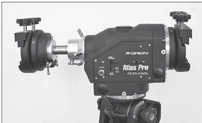
Figura 17. La montatura è ora configurata per accettare due telescopi in modalità altazimutale.
