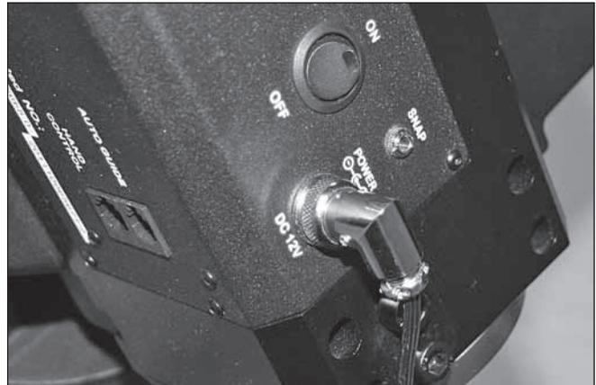
**Abbildung 18.** Der Winkelstecker des mitgelieferten 12V-Gleichstromkabels wird in den Netzanschluss an der Halterung gesteckt.
