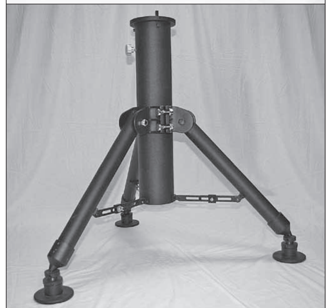
Figura 7. Las almohadillas de nivelación colocadas debajo de las patas del trípode ayudan a nivelar la montura.
