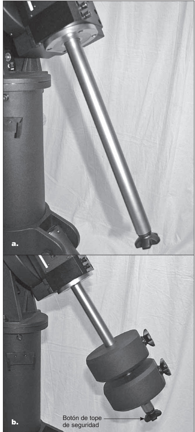
Figura 13. (a) El eje de contrapeso se enrosca en la montura. (b) Coloque los contrapesos y vuelva a colocar el botón de tope de seguridad.
