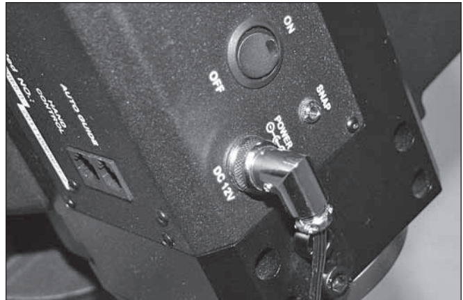
Figura 18. El conector en ángulo recto del cable de alimentación de 12 VCC incluido se enrosca en el conector de alimentación de la montura.
