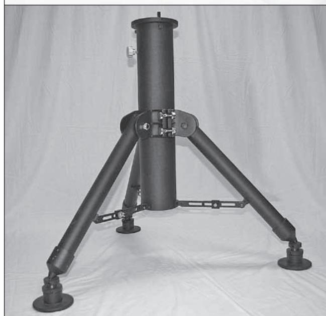
**Figure 7.** Patins de nivellement placés sous les pieds du trépied pour aider à mettre la monture de niveau.
