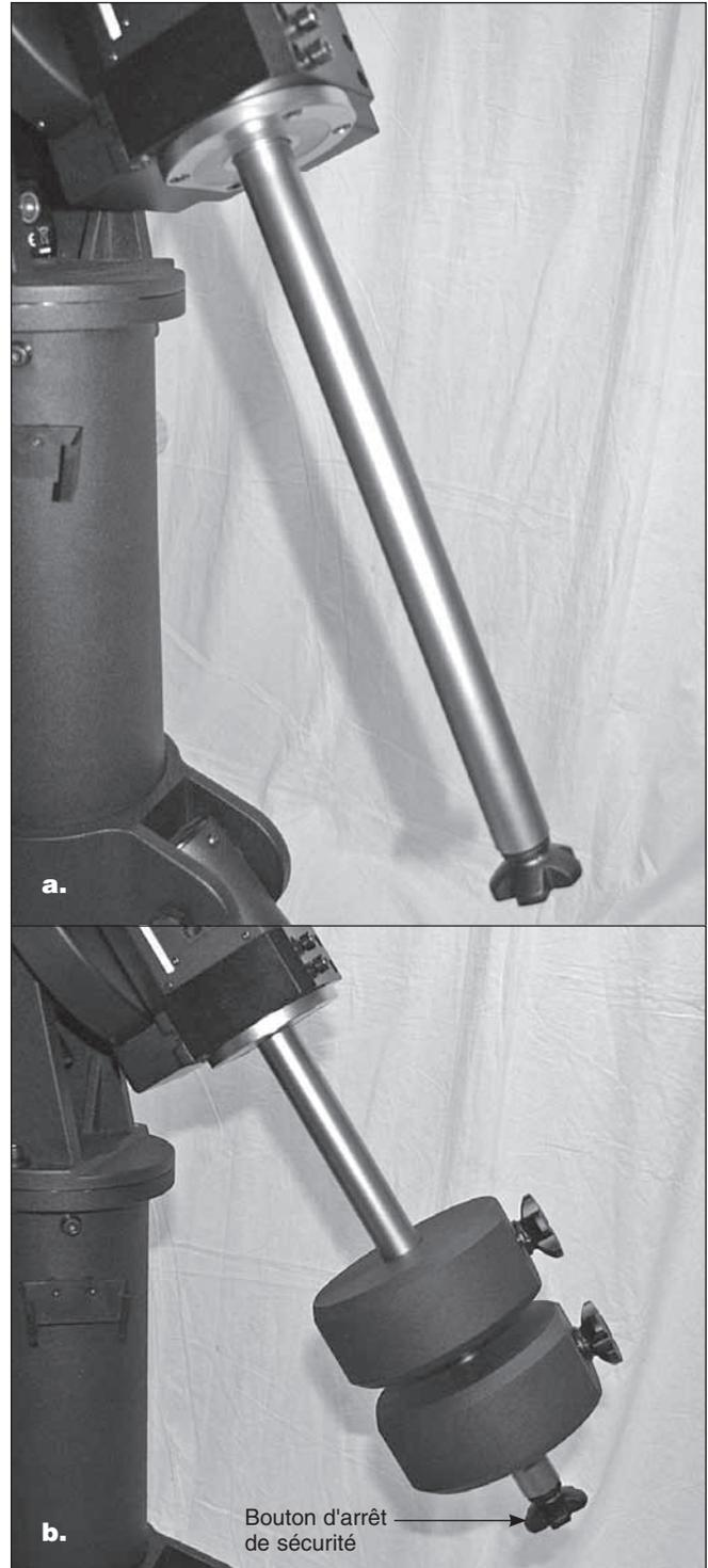
**Figure 13. (a)** La barre de contrepois se visse dans la monture. **(b)** Installez le(s) contrepois et remplacez le bouton d'arrêt de sécurité.
