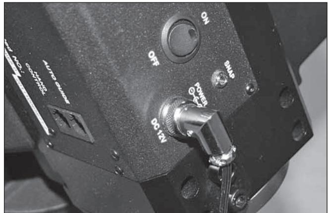
**Figure 18.** Le connecteur à angle droit du câble d'alimentation 12 V CC fourni se visse sur le connecteur d'alimentation sur la monture.
