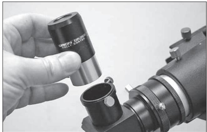
**Figure 7.** Insérez le barillet chromé de l'oculaire dans la diagonale et fixez-le avec les deux vis. Pour les modèles de télescopes StarSeeker III, l'oculaire s'insère directement dans l'adaptateur d'accessoire du porte-oculaire.
