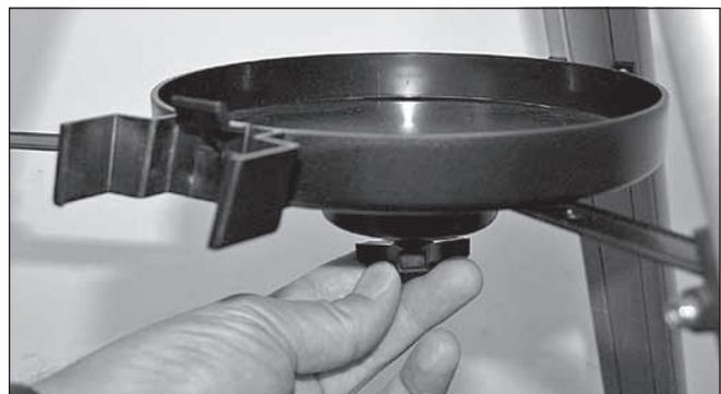
**Figure 3.** Le plateau d'accessoires rond se fixe au renfort du montant du trépied avec la vis imperdable sur le renfort.
