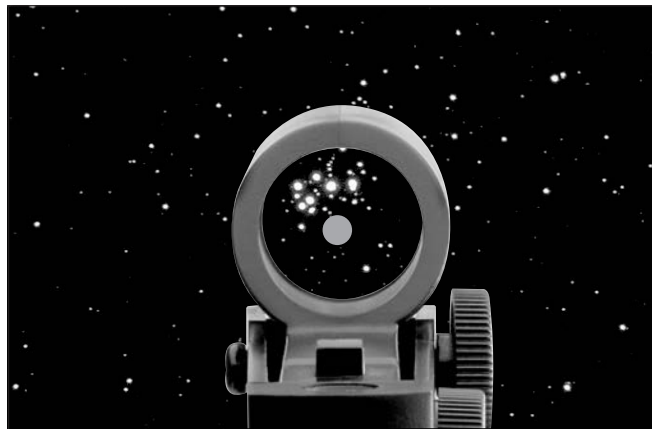
Figure 7. L'EZ Finder II superpose un petit point rouge (ce n'est pas un laser !) sur un champ de vision non-agrandi, ce qui permet de centrer un objet dans le champ de vision du télescope..
