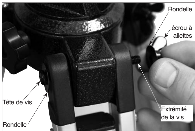
Figure 2. Fixez les montants du trépied sur le support avec les vis fixées sur le haut de ces montants. Placez une rondelle entre la tête de vis et le montant du trépied, et l'autre rondelle entre l'écrou à ailettes et le montant du trépied.
