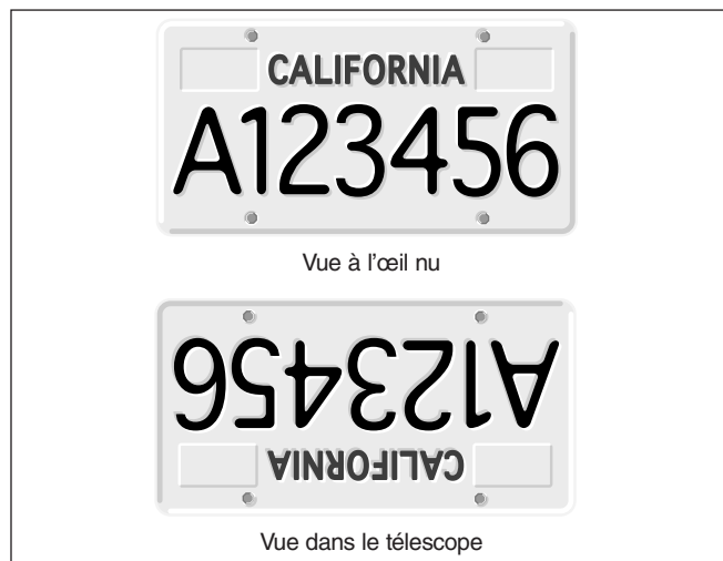
Figure 8. L'image aperçue dans un télescope à réflexion est inversée à 180°
