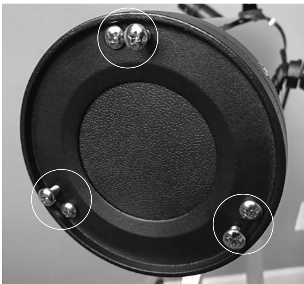
Figure 16. Alignement du miroir primaire par ajustement des trois paires de vis "tirez-pousser" à l'extrémité arrière du tube optique.
