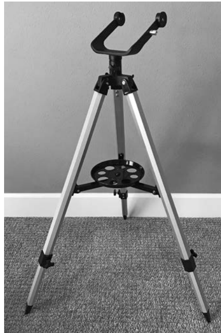
Figure 7. La monture azimutale et le trépied assemblés.
