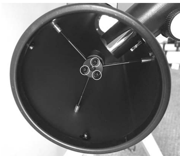
Figure 15. Ajustement de l'inclinaison du miroir secondaire par ajustement des trois vis d'alignement à l'aide d'un tournevis cruciforme.
