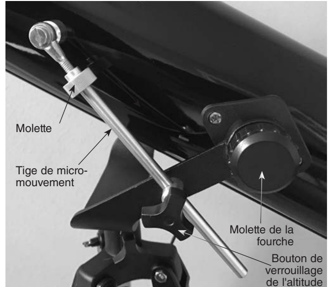
Figure 13. La tige et la molette de micro-mouvement permettent un contrôle fin du pointage d'altitude.
