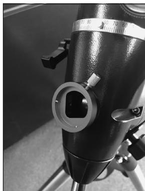
**Abbildung 2.** Das Teilstück mit dem Montierungsring wird in die Polarachsenöffnung der Montierung eingesetzt.
