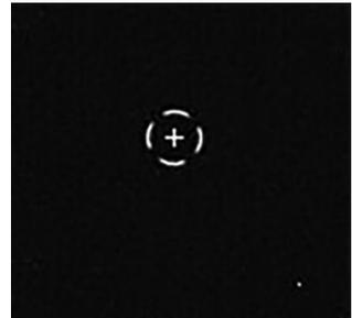
**Abbildung 8.** *Der kleine rotierende Kreis. Verwenden Sie die Polareinstellungen der Montierung, um den Polarstern in diesem Kreis zu positionieren.*
