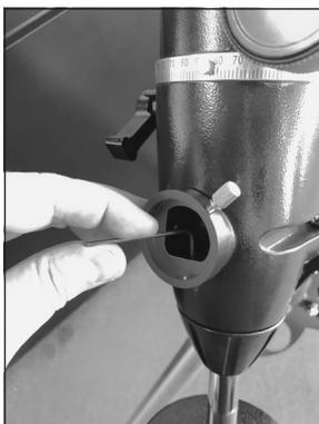
**Abbildung 3.** Ziehen Sie die beiden Stellschrauben mit dem mitgelieferten Inbusschlüssel an. Es gibt nicht viel Bewegungsspielraum für den Schlüssel, so dass es ein paar Umdrehungen brauchen kann, um die Schrauben anzuziehen.
