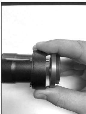
**Abbildung 4.** Schrauben Sie das Teilstück mit dem Basisring mit den mitgelieferten Schrauben und einem Schraubendreher an die Rückseite der Kamera.
